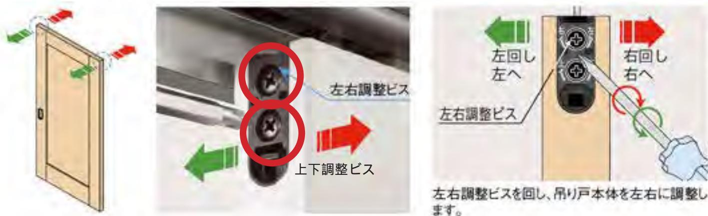
左右調整ビスを右に回すと本体が右に移動し、左に回すと本体が左に移動します。
